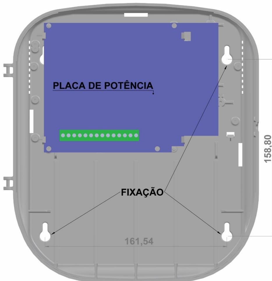
Figura 5. 2: Locais destinados para fixação da central.
