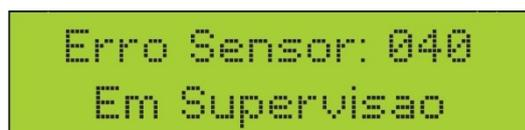
Figura 7. 5: Mensagem erro de comunicação com sensor.
