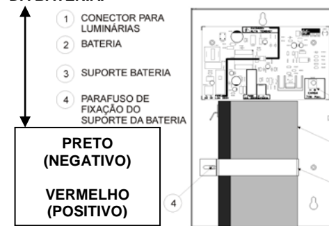
Figura 4: Fixação da bateria.
